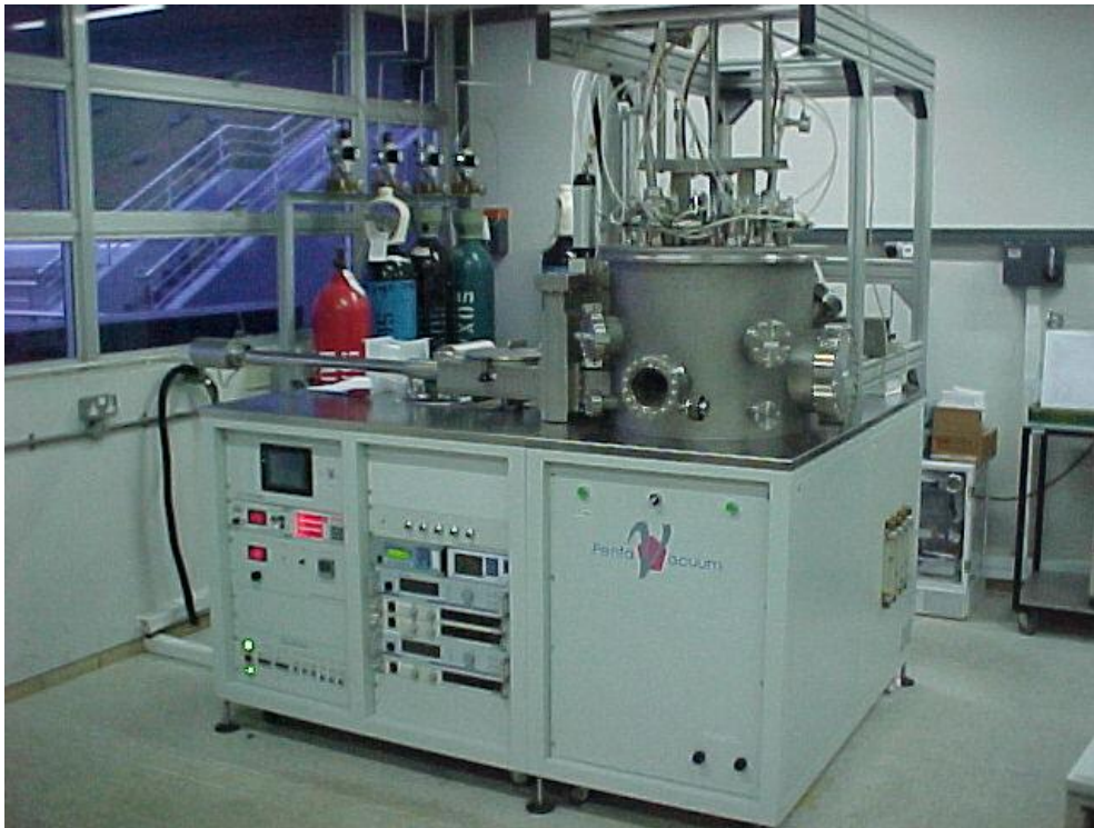
Hình 2.1. Hệ thống E303A phún xạ magnetron
